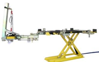
**1330BC PH.1ROTELSC06** JOLLIFT Hebebühne (Überflur) und Richtbank, komplett mit Hebebühne, 3.000 kg Tragkraft, Hubhöhe eff. 1.300mm, Überfahrhöhe 105mm, 2,20m lang, 1 Steuerpult **pneumohydraulisch**, 4m Leitung, 4 schwenkbare Aufnahmeearme, 4 Arme für Spannklemmen, 4 kleine Aufnahmeklemmen in der Höhe bis 10 cm verstellbar, 1 Zugerät mit effektiv 5 T Zugkraft, 8 Gummiauflagen
