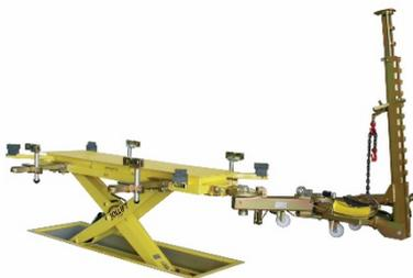
**Jollift Flex35.10TFL08** JOLLIFT Hebebühne (Unterflur) und Richtbank, komplett mit Hebebühne, 3.500 kg Tragkraft, Hubhöhe eff. 1.640mm, Einbauhöhe 300mm, 2.36m lang, 1 Steuerpult **elektrohydraulisch**, 5m Leitung, 4 schwenkbare Aufnahmeearme, 4 Arme für Spannklemmen, 4 Aufnahmeklemmen in der Höhe bis 30cm verstellbar, 1 Zugerät doppelt drehbar mit effektiv 10 T Zugkraft, 8 Gummiauflagen
