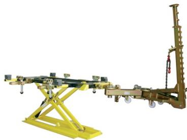
**MASB35.10TFL08** JOLLIFT Hebebühne (Überflur) und Richtbank, komplett mit Hebebühne, 3.500 kg Tragkraft, Hubhöhe eff. 1.640mm, Überfahrhöhe 105mm, 2,40m lang, 1 Steuerpult **elektrohydraulisch**, 5m Leitung, 4 schwenkbare Aufnahmeearme, 4 Arme für Spannklemmen, 4 Aufnahmeklemmen in der Höhe bis 30cm verstellbar, 1 Zugerät doppelt drehbar mit effektiv 10 T Zugkraft, 8 Gummiauflagen
