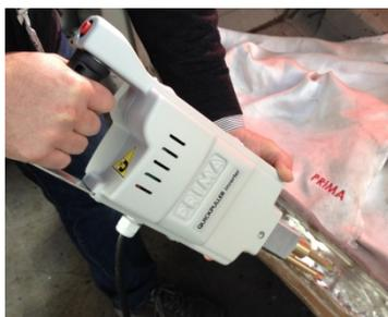
**QUICK PULLER**, ein Patent von PRIMA. Ein tragbarer Spotter (Hochfrequenz Inverter) mit Griff als Schlaghammer, geringem Gewicht und die Masse ist direkt an dem Gerät neben der Ausbeulspitze. Von daher muss kein Blech speziell für die Masseblank geschliffen werden.
